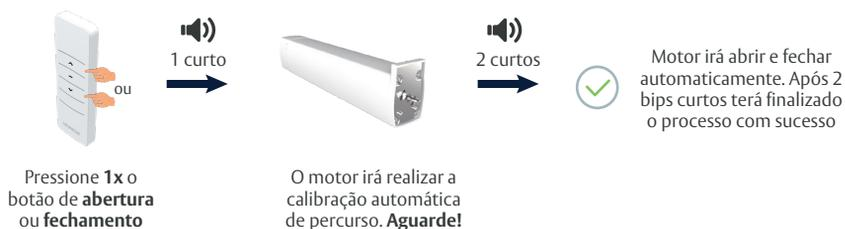
Após o motor finalizar o processo acima, é possível realizar os acionamentos normalmente de **Abertura, Parada e Fechamento**.
