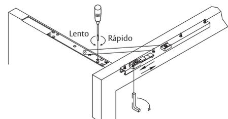
**OBSERVAÇÃO:** Siga a instrução de instalação da mola da porta, e você deve ajustar o regulador a fim de adequar a velocidade para seu fechamento normal. Para evitar qualquer mau funcionamento resultando em danos no mecanismo, não abra a folha da porta sem o ajuste de velocidade. (O regulador de velocidade não pode dar mais que 3 voltas)
