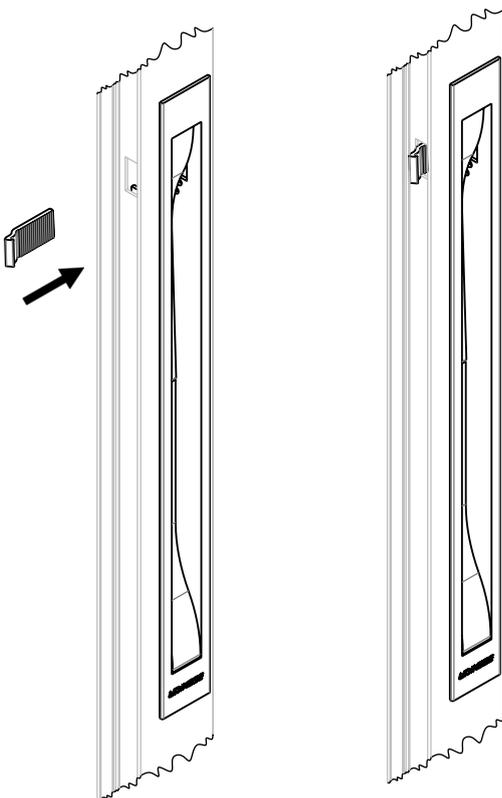
4. Apertar o Parafuso Allen Sem Cabeça M5 para fixar a Lingueta na posição desejada.
