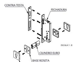
PASSO 1: RETIRAR AS CAPAS DAS BASES DAS ROSETAS ANTES DE REALIZAR A INSTALAÇÃO. COLOQUE UMA CHAVE DE FENDA (NÃO FORNECIDA PELA UDINESE) NAS FURAÇÕES DO LADO POSTERIOR DA BASE E EMPURRE A CAPA PARA DESMONTAR.
