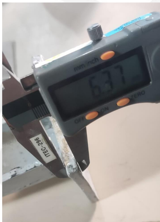
Foto nº. 04 Base de fixação – espessura
