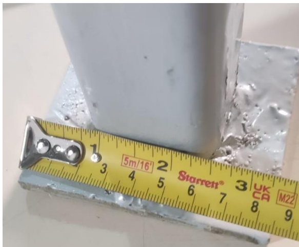
Foto nº. 05 Base de fixação – largura
