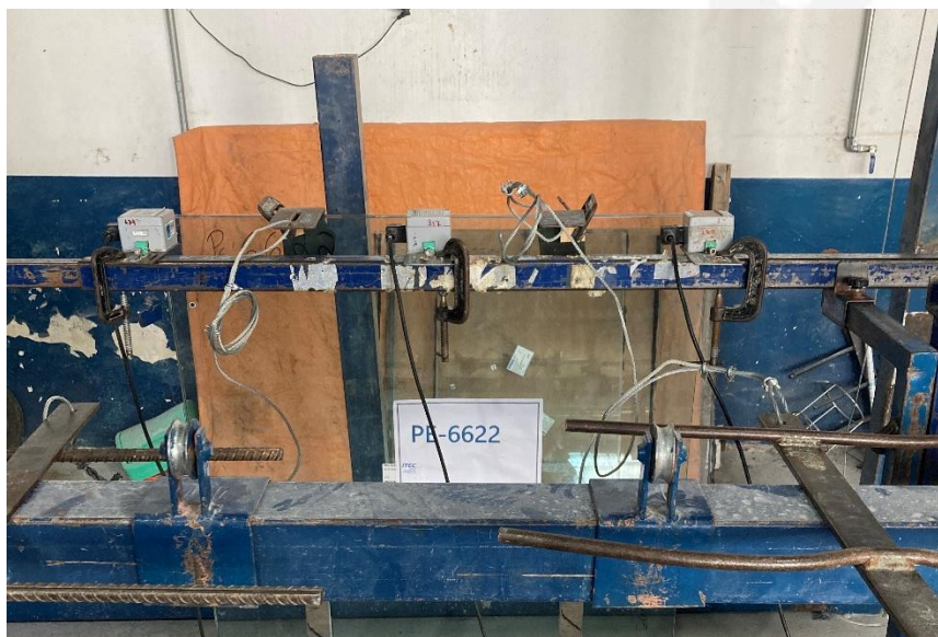
Foto nº. 06 Ensaio de determinação do esforço estático horizontal: Posicionamento dos deflectômetros
